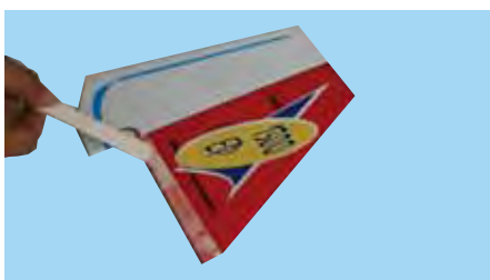
7E - Apply plenty of 30 minute epoxy
